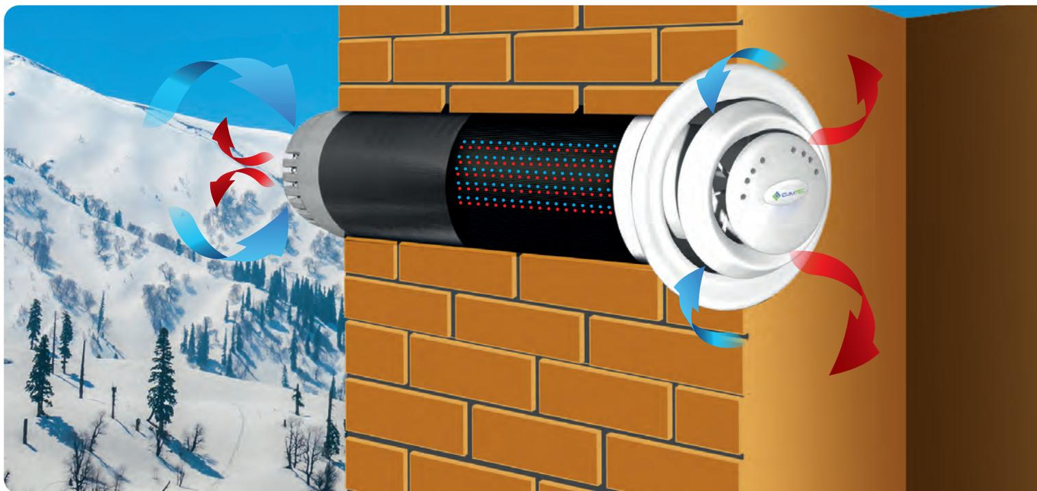
Потоки воздуха при этом не смешиваются, а движутся в разных каналах теплообменника. Благодаря этому происходит передача температуры от вытяжного воздуха к приточному (рекуперация). За счет этого обеспечивается энергоэффективность рекуперации до 93%.
